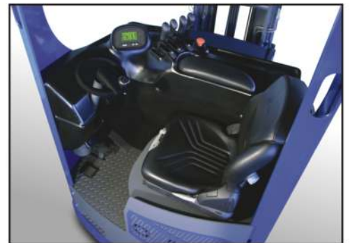
Célula do operador com controles gerais e display digital Curtis em cristal líquido.
